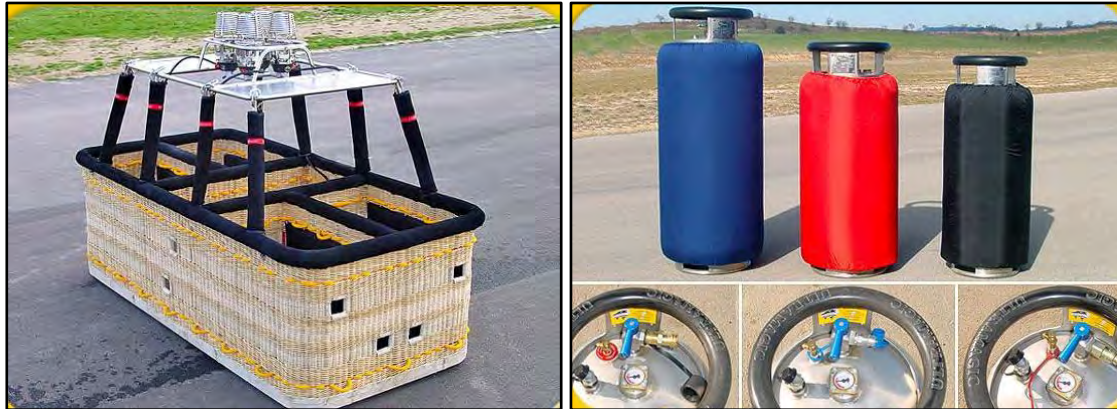
Fotoğraf 3-4. Balonun Unsurları. Sepet, Üstünde Burner Ve Propan Tüpleri ( www.ultramagic.com )
