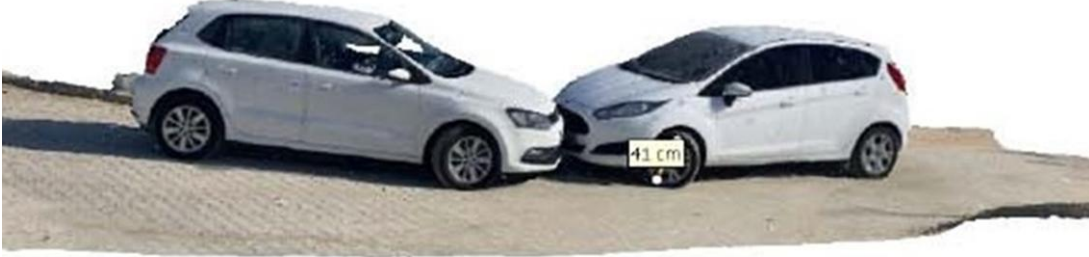
Şekil 4. Dijital Model Üzerinden Alınan Örnek Ölçüm (Araçlar Arası Mesafe).
